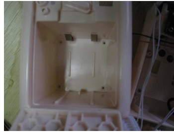
図 3 電池 BOX (コイン型電池無し)
