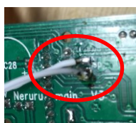
図 25 スピーカ線の半田付けのやり直し後の状態
