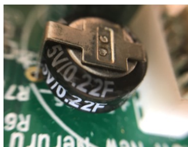
図 29 電気二重層コンデンサー
